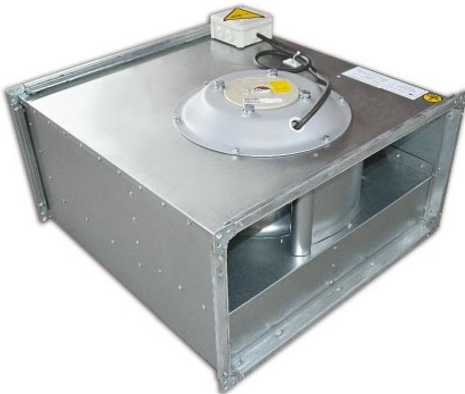
**+** Рабочие колеса вентиляторов выполнены из стального оцинкованного листа и имеют вперед загнутые лопатки. Рабочие колеса вентиляторов статически и динамически сбалансированы.
